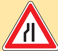
Einseitig verengte Fahrbahn
